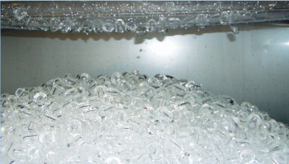
Eritme safhasında tüp buz küpleri buharlaştırıcı pimden çıkar.
