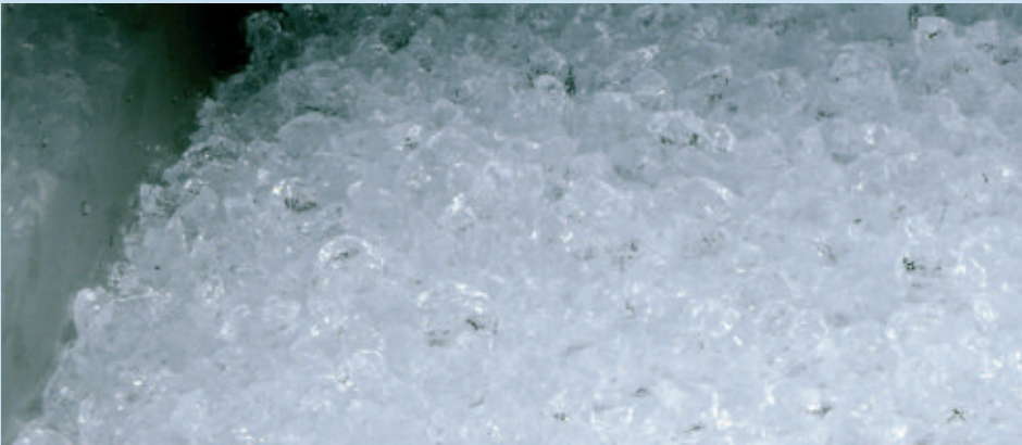
Tüp buz küplerinden üretilen kırık buz küpleri.
