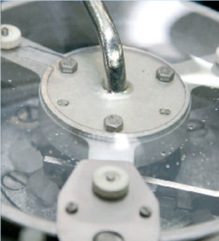
İletim konveyör ve basınç çekirdeğinden oluşan dondurucu silindir.
